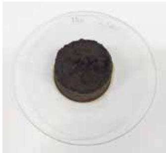
Şekil 6. HTK sonrası katı ürün Şekil 7. HTK sonrası sıvı ürün
