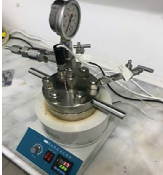
Resim1. 250 ml manyetik karıştırıcılı PID kontrollü hidrotermal reaktör
